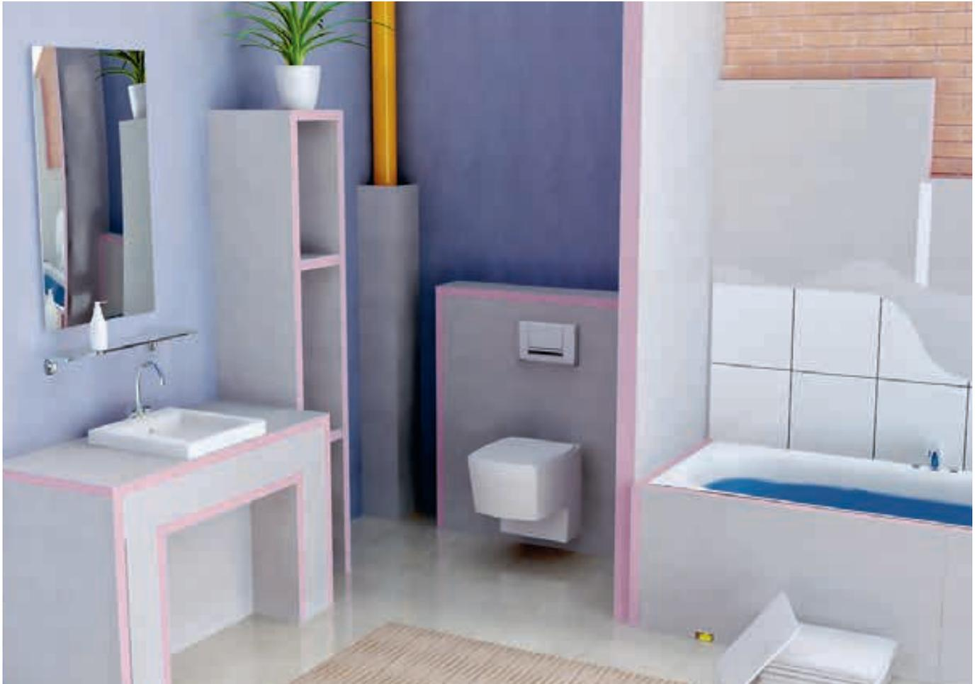
Die Austrotherm UNIPLATTE® ist ein ideales Trägerelement aus rosa extrudiertem Polystyrolhartschaum und beidseitiger, mit Textilglasgitter armierter Spezialmörtelbeschichtung. Sie ist wasserfest, wärmedämmend, stabil und speziell als Untergrund für die Fliesenverlegung im Dünnbettverfahren geeignet.
