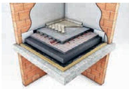
Austrotherm Trittschallrolle aus expandiertem Polystyrolhartschaumstoff mit aufkaschierter Gewebe- bzw. Alufolie. Austrotherm Trittschallrolle 650 bzw. Austrotherm Trittschallrolle 1000 ist zur Verlegung unter schwimmenden Gips-, Zement-, und Anhydritestrichen geeignet. Das Produkt kann auch unter Trockenestrichen und unter Industrieböden eingesetzt werden!
