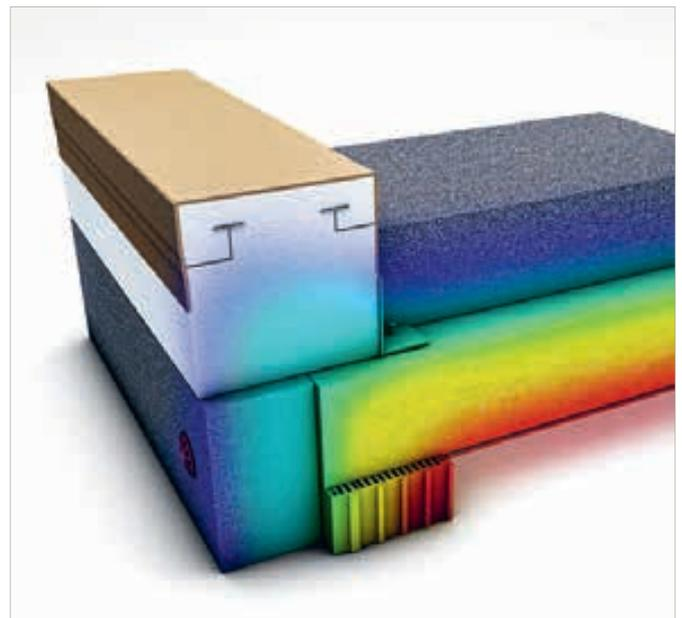
Im Vergleich zur herkömmlichen Attika können keine Wärmebrücken entstehen. Die Temperatur verläuft kontinuierlich über die gesamte gedämmte Außenhülle des Bauwerkes. Damit wird erfolgreich einer möglichen Schimmelbildung entgegengewirkt.
